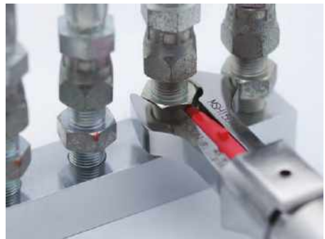
Líneas hidráulicas de proximidad cercana
